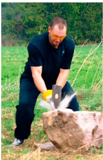
Kivide lõhkumine suurhaamriga ja nurgakivide lõhkumine. Fotod: A. Peebo
