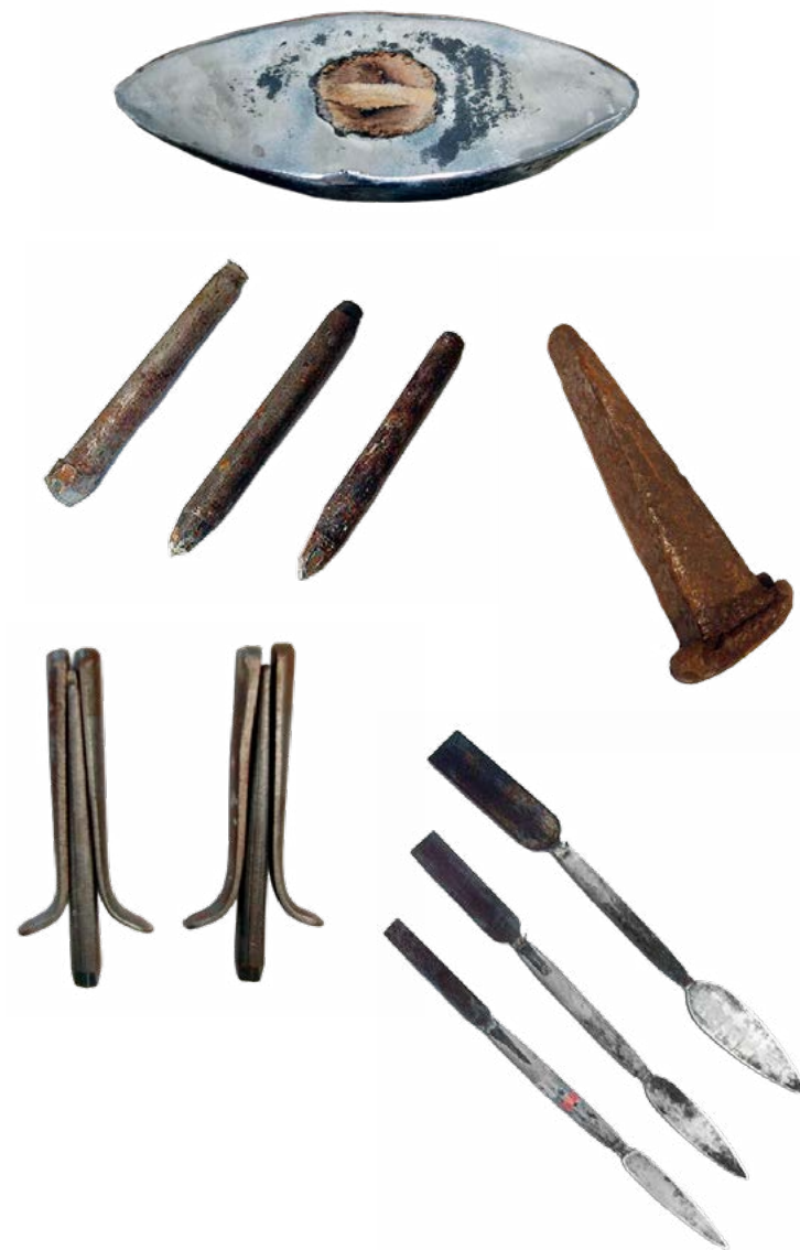
Tööriistad. Kahe pinniga kivilõhkumiskirves, ümarkiilud, meislid (vasakult: ponu, pardinokk või kulliküünis ja servameislid), lamekiil, eri laiusega vuugikellud. Fotod: A. Peebo
