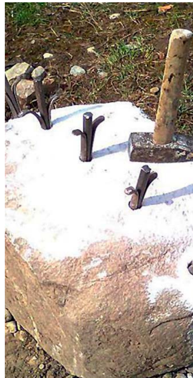
Kivide lõhkumine ümarkiiludega. Foto: A. Peebo
