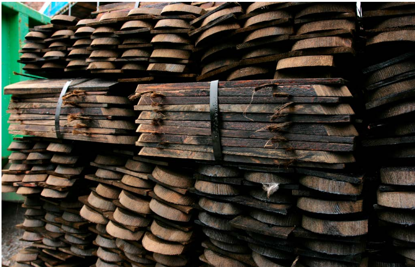
Eeltõrvatud kimmid. Pärast katusele paigaldamist tuleb neid veel kord tõrvata. Foto: D. Lukas
