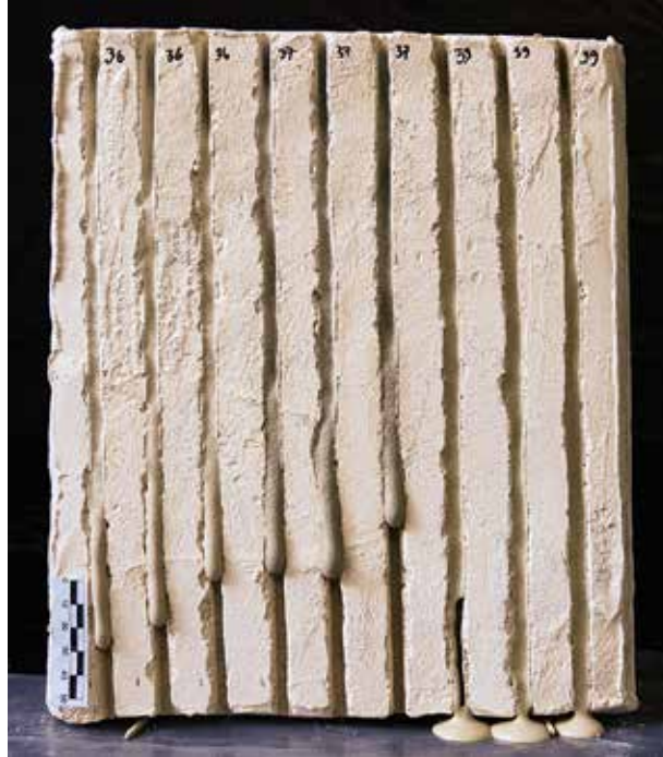
3. Injekteerimismörtide voolavuse katsetamine krohvipaneelil. Foto Varje Õunapuu
